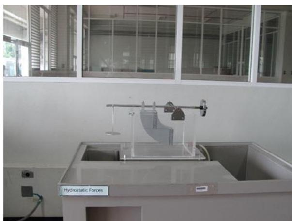
図8 流体推力測定実験
