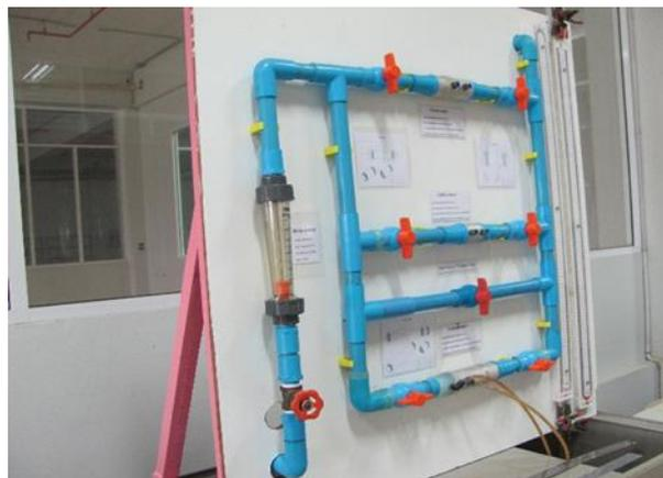
図6 分岐管流量実験
