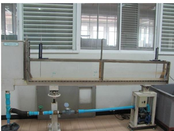
図4 三角堰による流量測定実験
