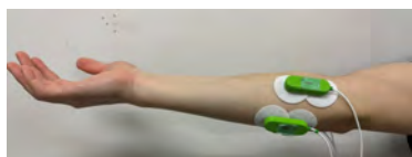
生体信号計測の一例(前腕の表面筋電位計測)
