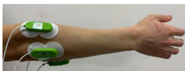
生体信号計測の一例(前腕の表面筋電位計測)
