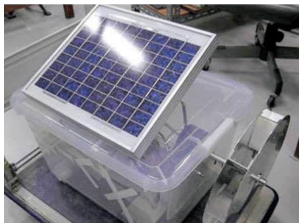
蓄電池を備えた太陽光・水力ハイブリッド発電機 （創造工学特別実験の試作品）
