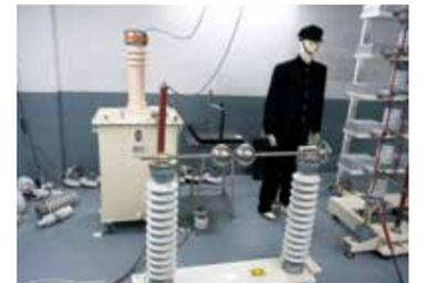
高電圧絶縁破壊実験（4年）
