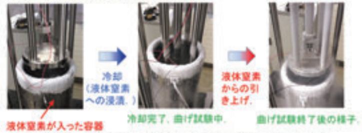
マイナス196℃での超電導材料の破壊強度試験
